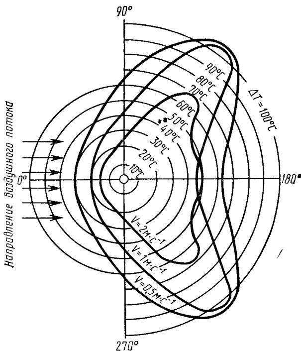
$\Delta T$  — превышение температуры поверхности образца над температурой окружающей среды;
