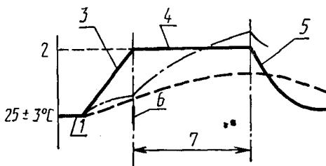
1 — образец, внесенный в испытательную камеру; 2 — температура испытания; 3 — скорость изменения температуры 0,7—1°C в минуту; 4 — температура воздуха в камере; 5 — скорость изменения температуры 0,5°C в минуту; 6 — образец включен (для испытаний в рабочем состоянии);
